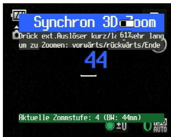
Das Laden dieses Skriptes kann über das Untermenü 'BenutzerSkripte' geladen werden, alternativ durch einen kurzen Druck auf die 'HotKey'-Taste (in der Regel die [DISP]-Taste, bei einigen Kameras, die keine [DISP]-Taste haben ist das die [PLAY]-Taste).
