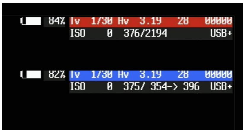
Liegt die Synchronität außerhalb dieses 1%-Bereiches, kann man den Synchronisationsprozess erneut starten, falls man die Synchronität für die aufzunehmende Szene als nicht ausreichend einschätzt. Dazu wechselt man in den ALT Modus und drückt [SET]. Der Synchronisationsprozess beginnt dann, wie oben beschrieben, mit dem blauen Rechteck.
