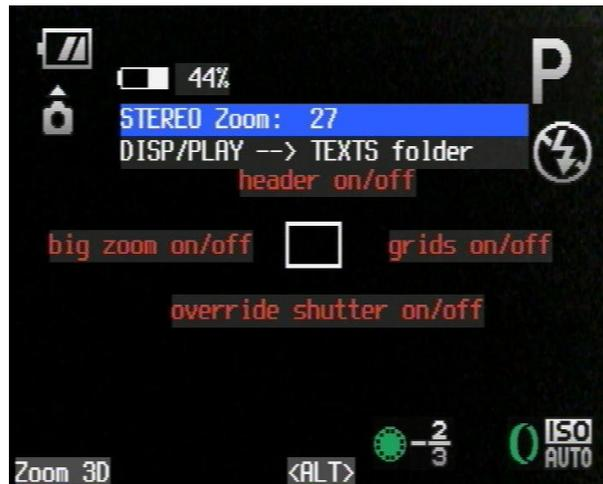
Einmal im ALT Modus (<ALT> wird unten mittig dargestellt), bringt ein erneuter **LANGER** Druck auf [MENU] das SDM Menü zum Vorschein. Das SDM Menü kann jederzeit durch Drücken von [MENU] verlassen werden, ein weiterer kurzer Druck auf [MENU] beendet dann den ALT Modus und die Kamera ist wieder im vorherigen Aufnahme- oder Wiedergabemodus.
