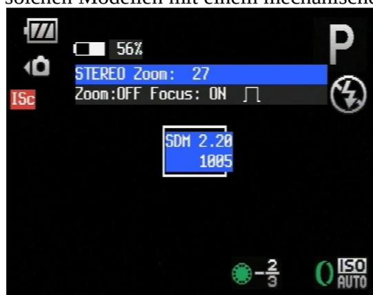
Wenn die Kamera fokussiert und der Fokus-Abbruch-Modus aktiv ist, wechseln drei Klicks des externen Auslösers zum Video-Modus. Ein Klick fokussiert, nächster Klick startet die Videoaufnahme, anschließender Klick stoppt die Videoaufnahme. Einige Kameras kehren dann zum vorherigen Modus zurück, verlieren aber dabei die Videosynchronität. Ansonsten kehren drei Klicks in den vorherigen Modus zurück. Die Zwei-Klick Zoom-Methode funktioniert hier auch im Videomodus.
